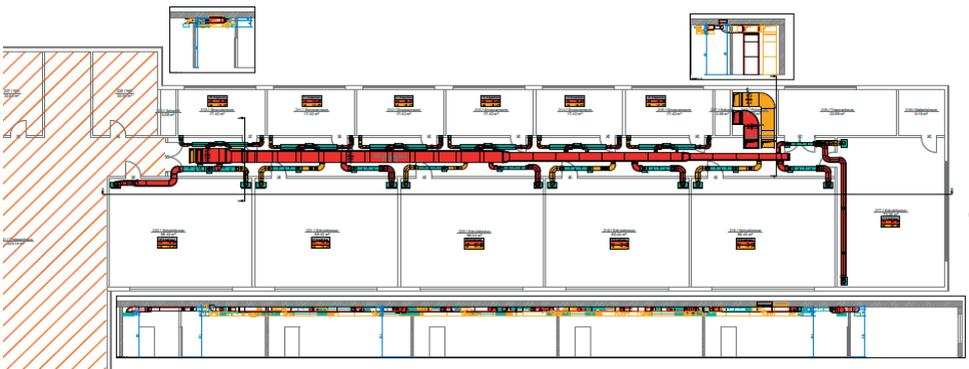
Die Klassenzimmer haben auf der dem Gang zugewandten Seite alle Wandschränke (siehe Abbildung 2). Die Zu- und Abluftkanäle und die jeweiligen Luftdurchlässe werden in diese Schrankelemente integriert – mit der grösstmöglichen Distanz zwischen Zu- und Abluft. Dies sorgt für eine optimale Luftzirkulation.
